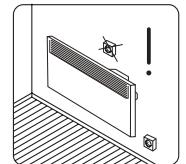
Конвектор не предназначен для размещения непосредственно под гнездом розетки.
