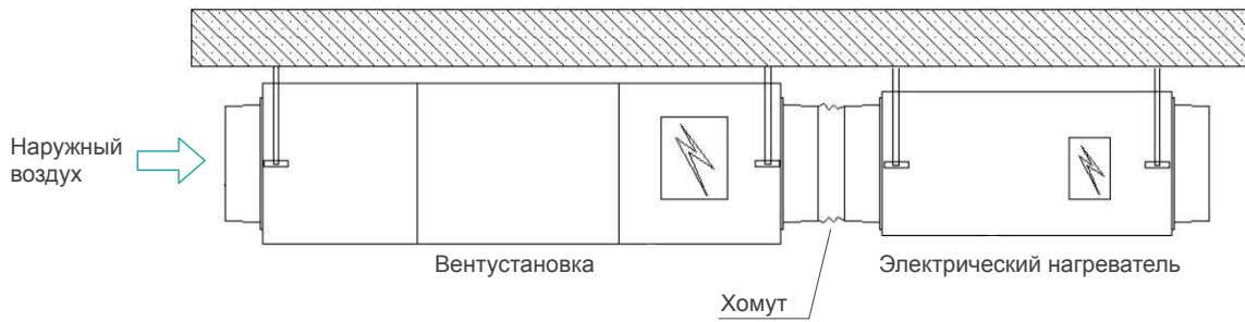
Монтаж электрического нагревателя
