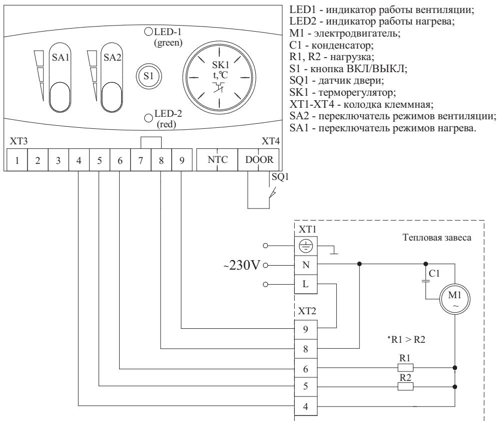
**Рисунок 17. Схема электрическая подключения нескольких завес к одному контроллеру**
