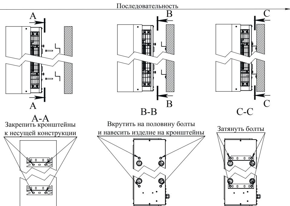
Рисунок 13. Схема крепления завесы вертикально к стене с помощью кронштейнов.
