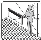
Конвектор следует устанавливать так, чтобы человек принимающий ванну или душ не мог дотронуться до блока управления.
