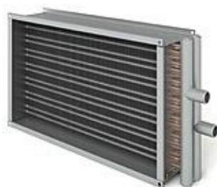
В оборудовании применяется двухрядный\* медно-алюминиевый водной нагреватель. Нагреватель защищен от коррозии. Водяной нагреватель имеет систему защиты от замораживания по датчику температуры поверхности нагревателя и по датчику температуры обратной воды.
